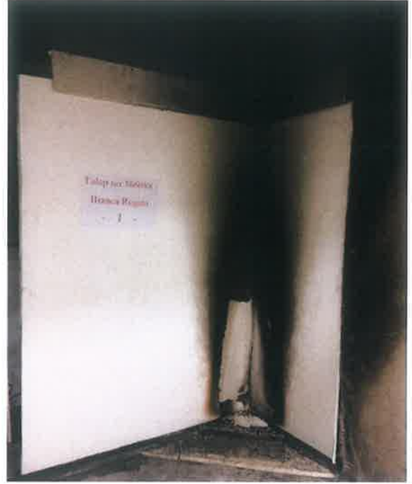
Fotoğraf 4. Numune 1'e ait deney sonrası köşe detayı
