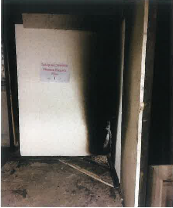
Fotoğraf 3. Numune 1'e ait deney sonrası uzun kanat detayı
